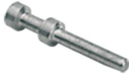
Contatto a crimpare maschio, serie CC, 16 A, tornito, ferro (Fe), sezione conduttore 0,5 mm<sup>2</sup>, AWG 20
