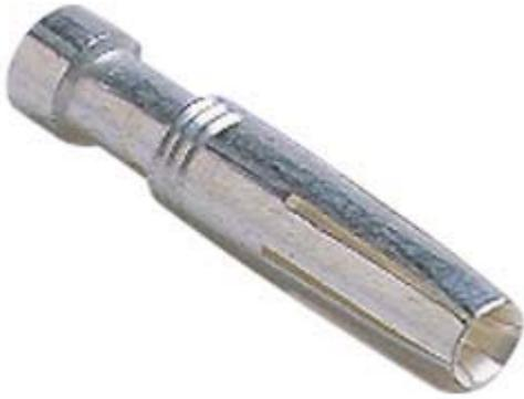
Contatto a crimpare femmina, serie CC, 16 A, tornito, costantana (Cu Ni), sezione conduttore 0,5 mm<sup>2</sup>, AWG 20
