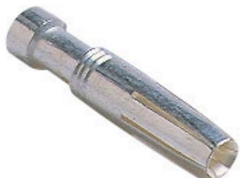
Contatto a crimpare femmina, serie CC, 16 A, tornito argentato, sezione conduttore 3 mm<sup>2</sup>, AWG 12
