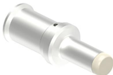
Contatto a crimpare maschio, serie C30, 300 A, tornito argentato, sezione conduttore 120 mm<sup>2</sup>, AWG 4/0, versione finger-proof
