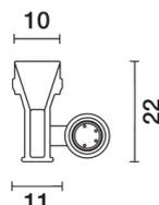
versione Side-Bend 10mm - Led Warm white - 24Vdc - L= 304mm
