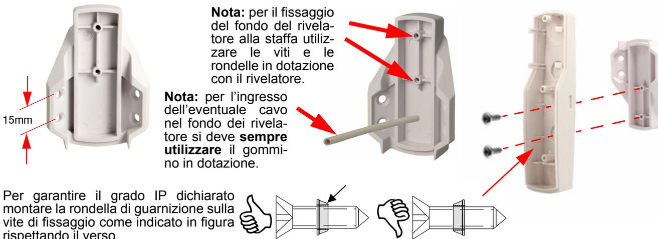
Per garantire il grado IP dichiarato montare la rondella di guarnizione sulla vite di fissaggio come indicato in figura rispettando il verso.
