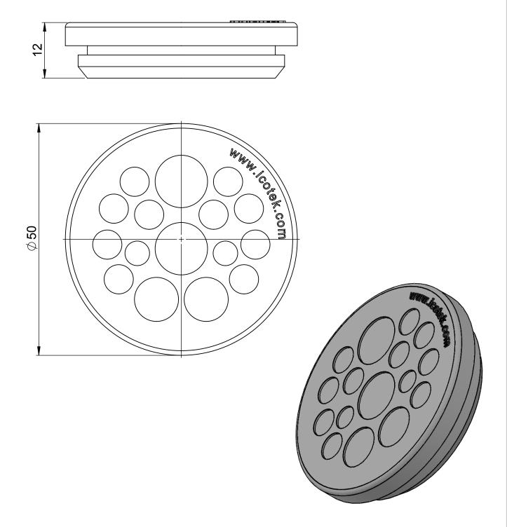
Kabeldurchführungsplatte KEL-DP 40/16 A für Blechstärke 1,5 bis 2,5 mm 2 x 11,3mm + 2 x 9,5mm + 10 x 6,3mm + 2 x 5,3mm
