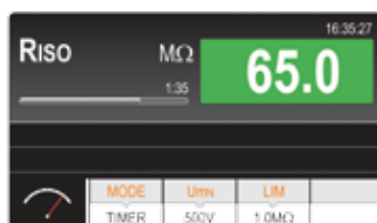
Misura di resistenza di isolamento
