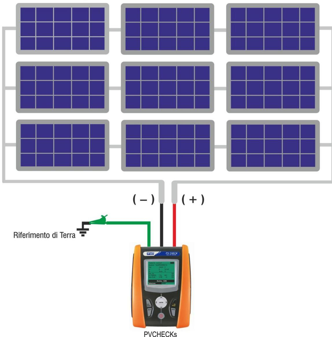
Misura diretta della resistenza di isolamento di un Campo FV non collegato a terra
