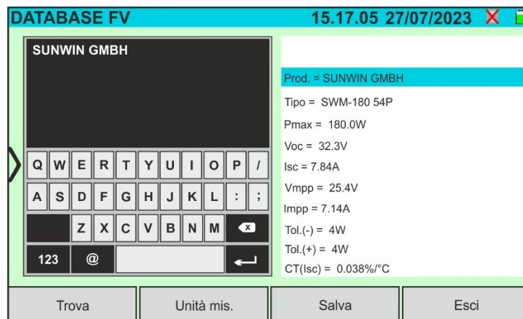
Fig. 28: Modifica modulo esistente
