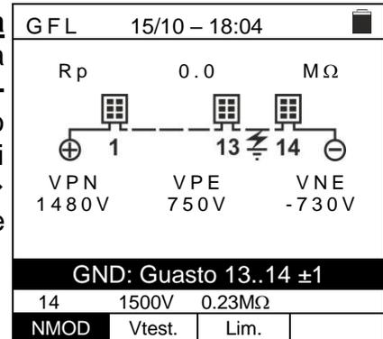
15. **In presenza di guasto ( $R_p < Lim$ ) all’interno della stringa**, lo strumento mostra la videata a lato e il messaggio (relativo all’esempio con  $NMOD = 46$ ) “**GND: Guasto 8..9  $\pm N$** ” a display. Controllare lo stato di isolamento delle scatole di giunzione dei moduli indicati e relativi cavi di collegamento. Nel caso di figura, avendo  $NMOD=46 \rightarrow$  Tolleranza =  $\pm 3$ , il guasto può trovarsi tra il 5° modulo e il 12° modulo
