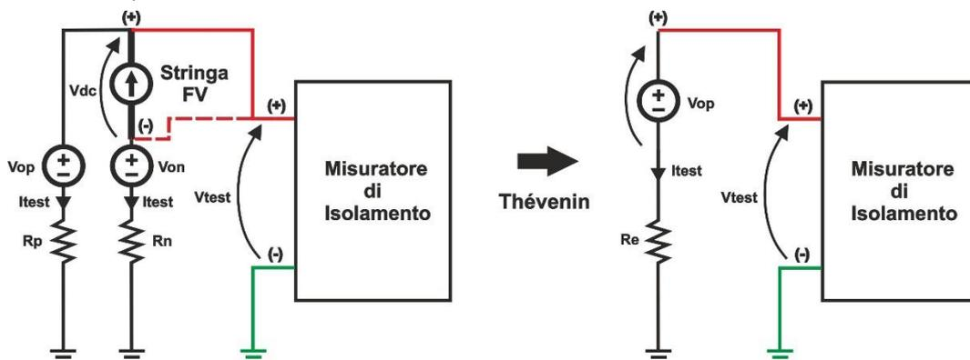
Fig. 15: Schema e circuito equivalente del Metodo 1
