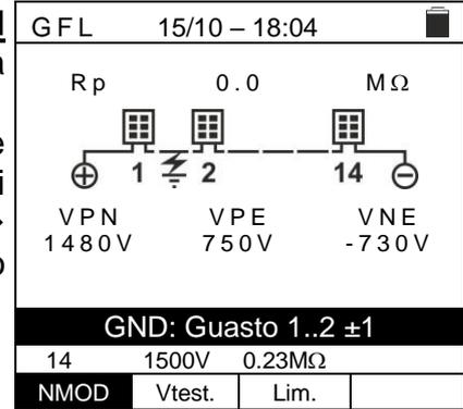
14. **In presenza di guasto ( $R_p < Lim$ ) in posizione NMOD (tra il penultimo e l’ultimo modulo)**, lo strumento mostra la videata a lato e il messaggio “**GND: Guasto NMOD-1..NMOD  $\pm N$** ” a display. Controllare lo stato di isolamento delle scatole di giunzione dei moduli indicati e relativi cavi di collegamento. Nel caso di figura, avendo  $NMOD=14 \rightarrow$  Tolleranza =  $\pm 1$ , il guasto può trovarsi tra il 12° modulo e dopo l’ultimo modulo
