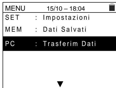
5. **Se occorre usare il collegamento WiFi** attivare il modulo interno (vedere § 5.1.3). In tal caso lo strumento fornisce la videata seguente:
