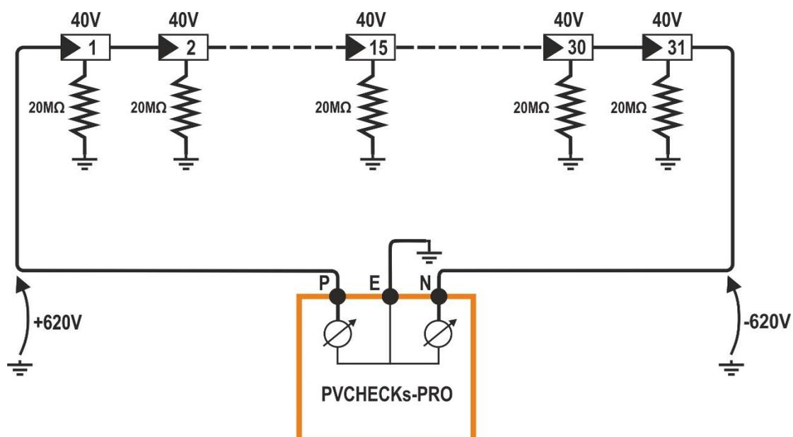
Fig. 14: Esempio di utilizzo della funzione GFL
