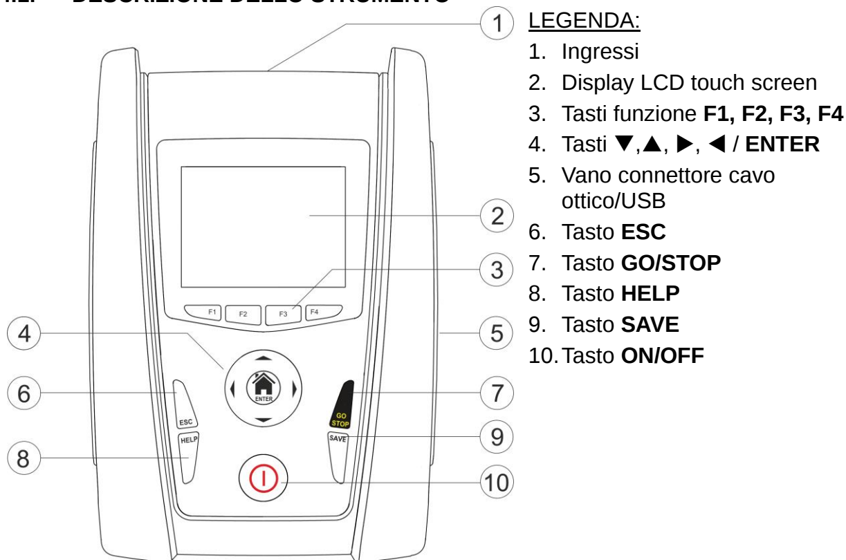
Fig. 1: Descrizione parte frontale dello strumento
