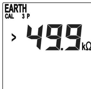
6. Qualora il circuito Voltmetrico (terminale S) presenti una resistenza troppo elevata, sul display viene visualizzato il messaggio indicato a lato.
