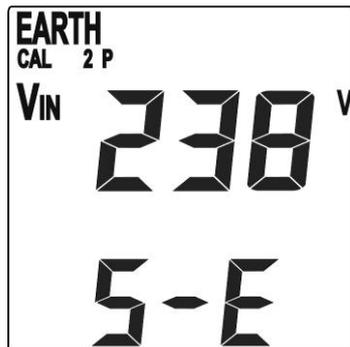
Valore della tensione rilevata in ingresso
