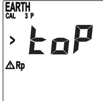
7. Qualora il circuito Amperometrico (terminale H) presenti una resistenza troppo elevata, sul display viene visualizzato il messaggio indicato a lato.
