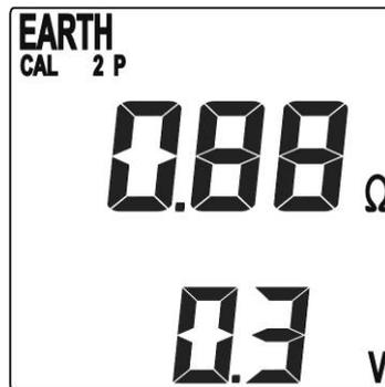
Valore misurato della Resistenza di Terra  $R_A + R_T$
