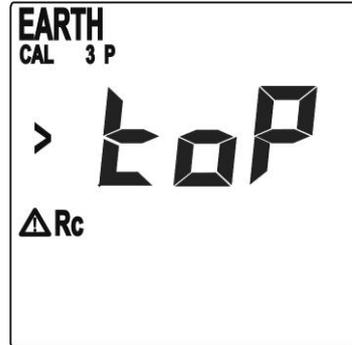
8. Qualora il circuito Voltmetrico ed Amperometrico (terminale S e H) presenti una resistenza troppo elevata, sul display viene visualizzato il messaggio indicato a lato.
