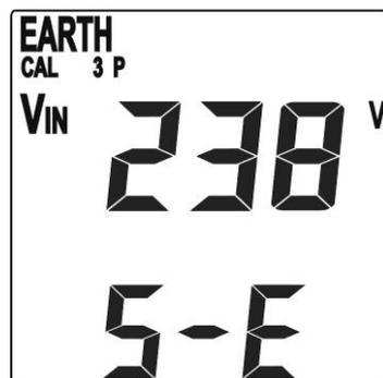
Valore della tensione rilevata in ingresso
