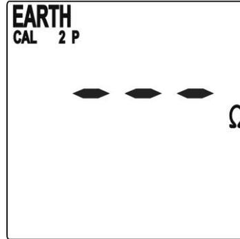
**Simbolo CAL:** indica che lo strumento è stato calibrato; questo simbolo rimane visualizzato per ogni successiva misura anche se lo strumento viene spento e riacceso
