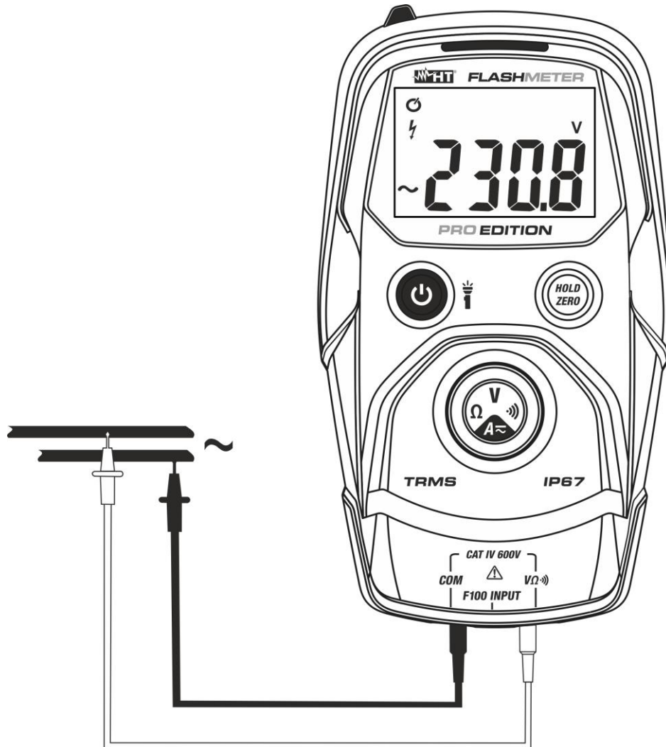
Fig. 4: Utilisation de l'instrument pour la mesure de la Tension CA
