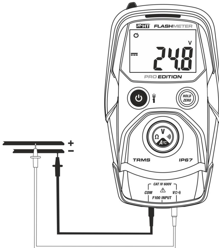
Abb. 3: Verwendung des Gerätes für Gleichspannungsmessung
