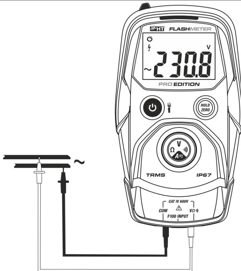
Abb. 4: Verwendung des Gerätes für Wechselspannungsmessung
