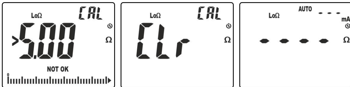
Fig. 34: Risultati azzeramento non eseguito correttamente
