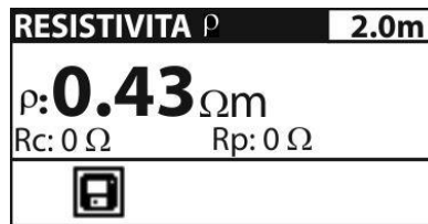
Fig. 29: Videata finale misura resistività del terreno
