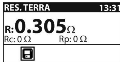
Fig. 26: Videata finale misura resistenza di terra
