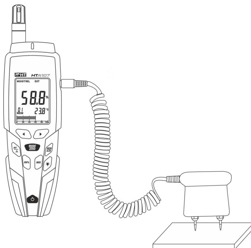
Fig. 9: Uso do instrumento para a medição da humidade por contacto com sonda externa
