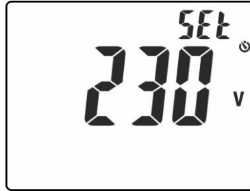
Fig. 6: Impostazione tensione nominale nelle misure di Loop
