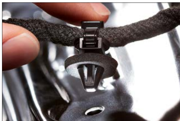
La guarnizione aggiuntiva protegge dall'ingresso di umidità.
