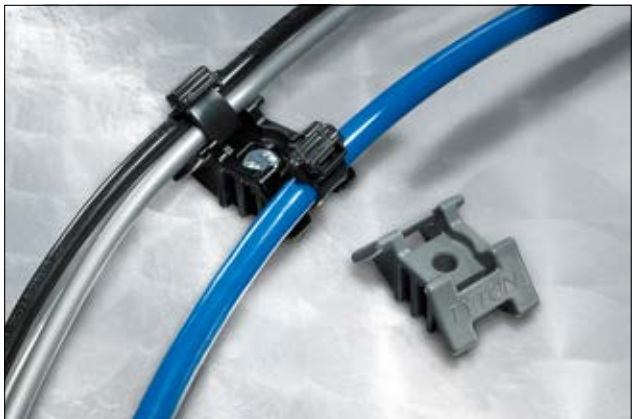
Questa basetta a sella è installata tra due cablaggi per mantenerli separati e proteggerli da sfregamenti e usura.
