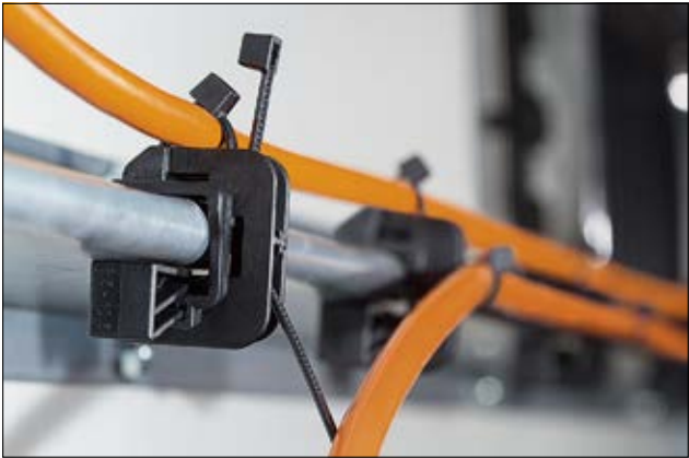
La Beam Clamp può essere fissata ad un fascio con un incastro. Si possono legare fino a due fasci di cavi sulla parte superiore o posteriore della clamp.
