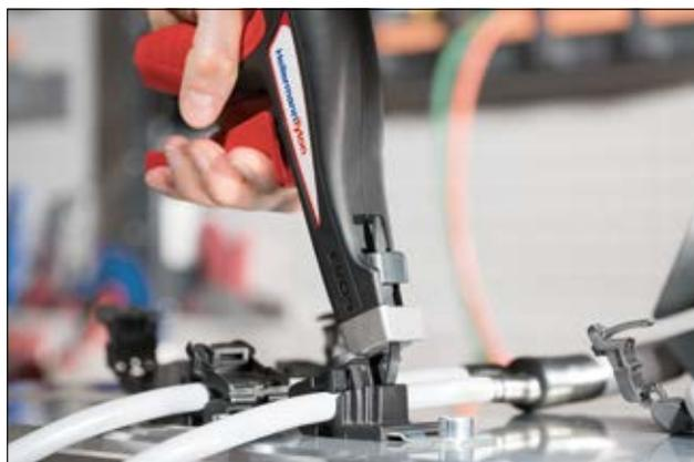
La linguetta di tensionamento consente di raggiungere un preciso valore di serraggio.
