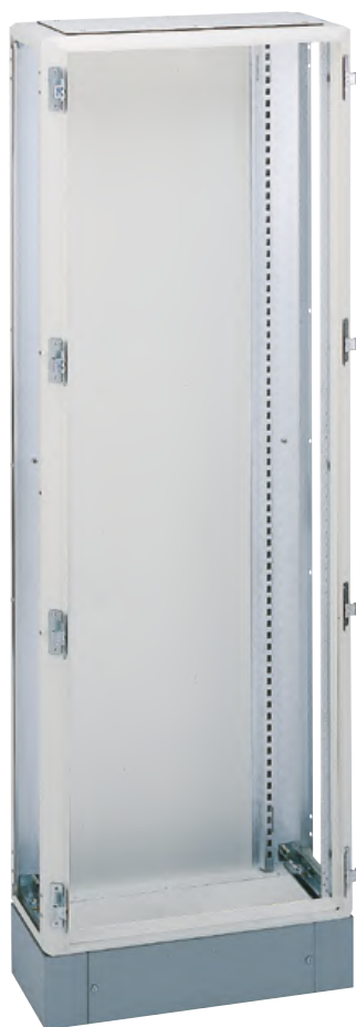
▲ struttura da pavimento profondità 260 mm con fianchi aperti, retro chiuso, piastre passacavi superiori ed inferiori, zoccolo con flange asportabili
