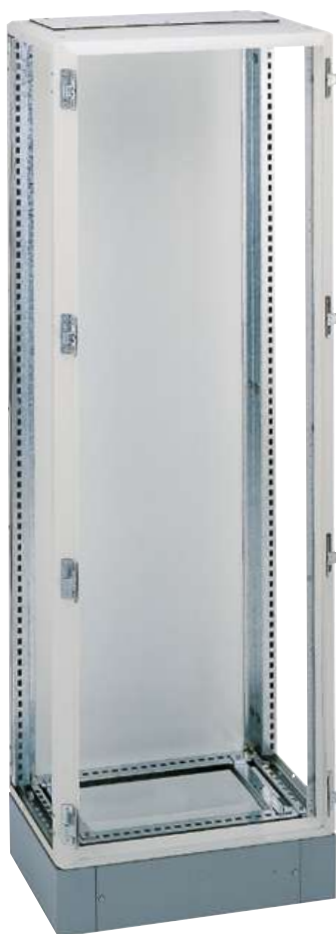
▲ struttura da pavimento profondità 400 mm con fianchi aperti, retro chiuso, piastre passacavi superiori ed inferiori, zoccolo con flange asportabili
