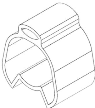
Tubetto trasparente che con poche referenze copre una vasta gamma di cavi. Se bruciato, non rilascia sostanze alogene e può essere impiegato nelle installazioni in ambienti a rischio.
