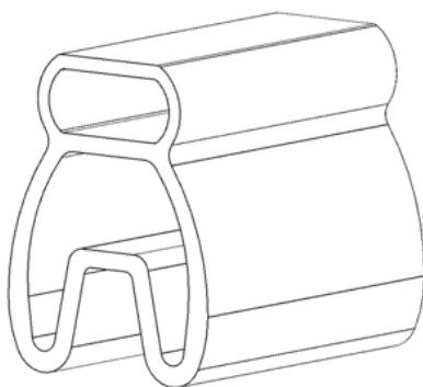
Tubetto trasparente che con poche referenze copre una vasta gamma di cavi. Se bruciato, non rilascia sostanze alogene e può essere impiegato nelle installazioni in ambienti a rischio.
