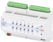
L'attuatore combinato KNX da guida DIN è dotato di 12 relè indipendenti da 8 AX con contatto normalmente aperto (NA), che consentono il controllo di 12 carichi in commutazione ON/OFF a 230 Vac oppure di 6 tapparelle o veneziane con motori a 230 Vac. Ogni coppia di canali può essere configurata in modo indipendente, permettendo di combinare liberamente uscite dedicate alla commutazione o al comando tapparelle.
