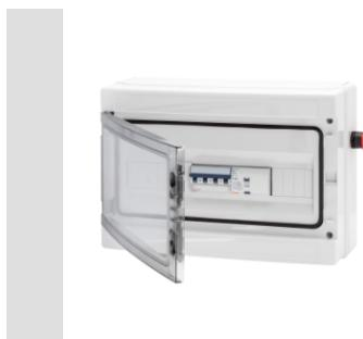
Quadri di alimentazione principale cantiere, Tipo QP e CDK. Vengono installati immediatamente a valle del contatore di energia e proteggono il tratto di cavo dal quadro di consegna al quadro di distribuzione generale di cantiere. Sono disponibili nelle versioni con corrente da 32 a 250A, tutte dotate di pulsante emergenza.
