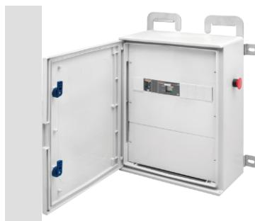
Quadri di alimentazione principale cantiere, Tipo QP e CDK. Vengono installati immediatamente a valle del contatore di energia e proteggono il tratto di cavo dal quadro di consegna al quadro di distribuzione generale di cantiere. Sono disponibili nelle versioni con corrente da 32 a 250A, tutte dotate di pulsante emergenza.
