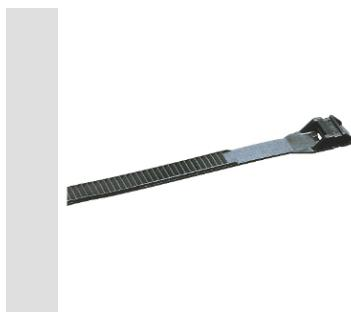
Fascette per esterno realizzate in PA12, sono l'ideale per l'ancoraggio arereo di apparecchiature e cavi in luoghi a basse temperature. Le fascette con doppia testina che permettono di incrementare la tenuta meccanica sono disponibili dalla taglia 9x265.
