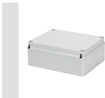
Gamma di cassette di derivazione stagne da parete serie 44 CE rispondenti alla norma ANSI/UL 50 e realizzate con tecnopoliimeri ad elevate prestazioni. La gamma si compone di versioni IP56 con pareti liscie e con coperchi ciechi, bassi , a vite (GWT960°C).
