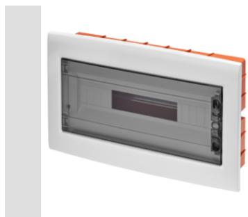
Gamma di centralini da incasso protetti IP40, disponibili nelle taglie da 2 a 72M, con porta trasparente fumè particolarmente indicati per i settori terziario ed industriale e con porta cieca, ideali per dispositivi domotici. Accessorabili con morsettiera bipolarie e unipolari da 80 A e 125 A, con cablaggio a vite, che consentono di realizzare un cablaggio semplice ed ordinato riducendo i tempi per la messa in opera del centralino.
