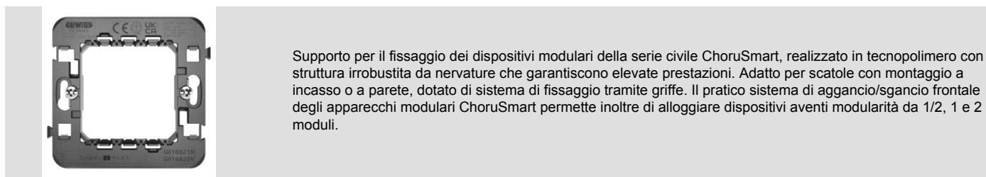
Supporto per il fissaggio dei dispositivi modulari della serie civile ChoruSmart, realizzato in tecnopoliomerio con struttura irrobustita da nervature che garantiscono elevate prestazioni. Adatto per scatole con montaggio a incasso o a parete, dotato di sistema di fissaggio tramite griffe. Il pratico sistema di aggancio/sgancio frontale degli apparecchi modulari ChoruSmart permette inoltre di alloggiare dispositivi aventi modularità da 1/2, 1 e 2 moduli.
