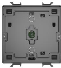
Interruttore assiale da incasso. Sulla parte frontale è dotato di un pulsante assiale per il comando di un carico ON/OFF (funzionalità bistabile/monostabile) o ON Temporizzato attraverso contatto di uscita con potenziale. Il dispositivo deve essere completato utilizzando le tipologie di tasti frontalibili. Dotato di n°3 DIP, posti sul retro del dispositivo, per la configurazione delle funzionalità.
