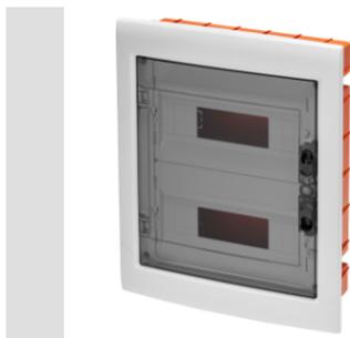
Gamma di centralini da incasso protetti IP40, disponibili nelle taglie da 2 a 72M, con porta trasparente fumè particolarmente indicati per i settori terziario ed industriale e con porta cieca, ideali per dispositivi domestici. Accessorizzabili con morsettiere bipolari e unipolari da 80 A e 125 A, con cablaggio a vite, che consentono di realizzare un cablaggio semplice ed ordinato riducendo i tempi per la messa in opera del centralino.
