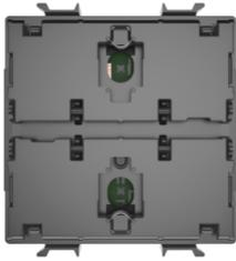
Comando motore da incasso. Dispositivo per la movimentazione di tapparelle, tende, veneziane, avvolgibili, ecc. attraverso 2 contatti di uscita interbloccati con potenziale. Sulla parte frontale è dotato di due pulsanti assiali per la movimentazione verso l'alto (UP) e verso il basso (DOWN) e per la regolazione dell'inclinazione delle lamelle.
