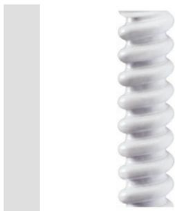
Sistema di tubi protettivi flessibili serie DF LIGHT realizzati in materiale termoplastico PVC con classificazione 1311. Rispondenti alle norme internazionali IEC 61386-1 (CEI 23/80) e IEC 61386-23 (CEI 23/83 per quanto applicabile). La gamma si compone di tubi disponibili in 4 diametri da 12 a 25 mm in colore grigio. Idonei per la protezione dei conduttori in installazioni fisse o mobili in applicazioni non gravose. Tipologia installazione: in vista a parete e soffitto.
