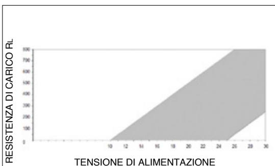
Nel diagramma riportato è rappresentato il rapporto ottimale tra il carico e l'alimentazione per trasmettitori con uscita 4...20mA. Per il corretto funzionamento si utilizzi una combinazione di resistenza di carico e tensione di alimentazione tali da rimanere entro la zona ombreggiata.
