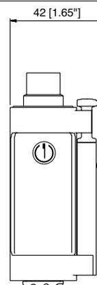
La funzione di Autozero è attivata mediante un contatto magnetico (magnete esterno fornito con il sensore). Per una completa spiegazione del funzionamento della funzione di Autozero consultare il manuale d'uso.
