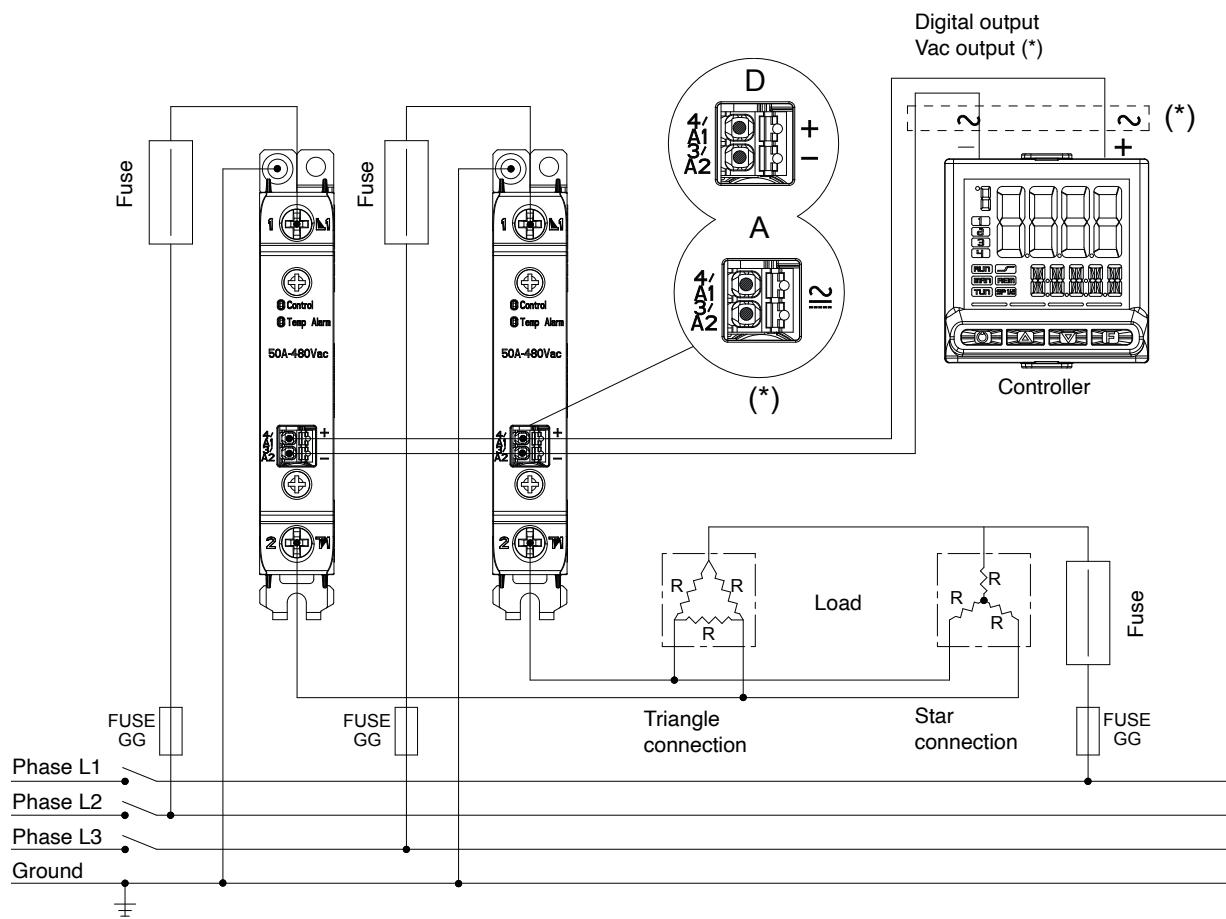
(\*) Oppure uscita relè con tensione uscita Vac (Utilizzare GRS-H con ingresso comando Vac, Tipo ingresso “A”)
