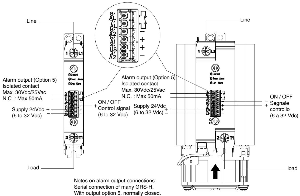
Esempio di collegamento per GRS-H con comando V AC con opzione allarme termico (Opzione 5)
