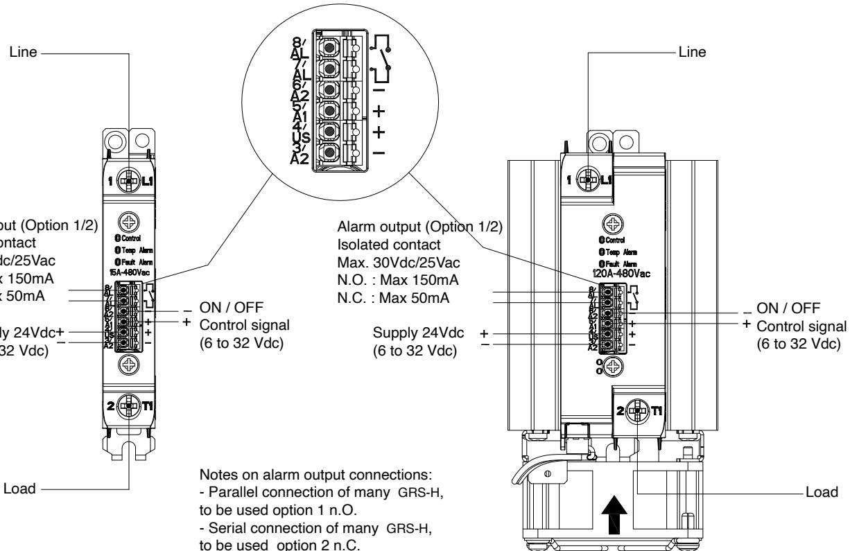
Esempio di collegamento per GRS-H con comando Vdc con opzione uscita allarme PNP (Opzione 3)
