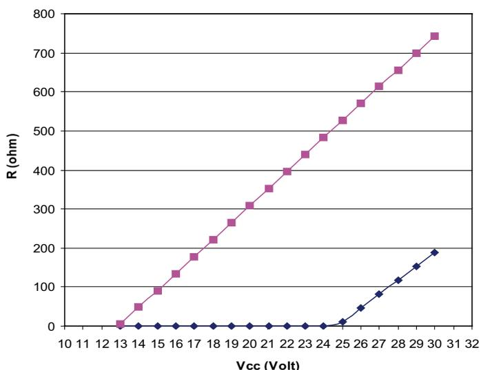
Nel diagramma riportato è rappresentato il rapporto ottimale tra il carico e l'alimentazione per trasmettitori con uscita 4...20mA. Per il corretto funzionamento si utilizzi una combinazione di resistenza di carico e tensione di alimentazione tali da rimanere entro le due linee tratteggiate.
