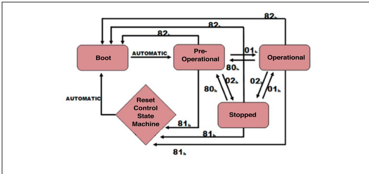
Ogni dispositivo CANopen contiene un server di gestione di rete interno che comunica con un master NMT esterno.
