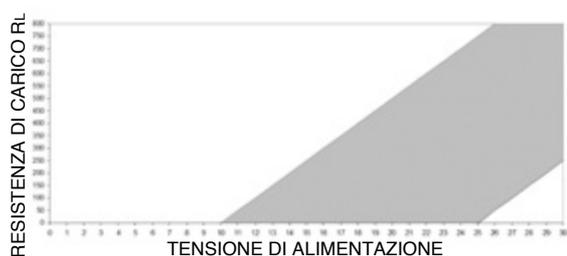
Nel diagramma riportato è rappresentato il rapporto ottimale tra il carico e l'alimentazione per trasmettitori con uscita 4...20mA.
