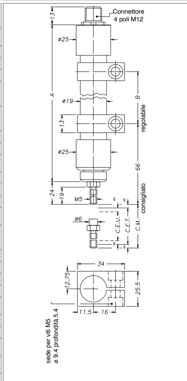
**Importante:** Tutti i dati riportati a catalogo per i valori di linearità, durata di vita, ripetibilità, coefficienti di temperatura, sono validi per l'utilizzo del sensore come partitore di tensione con una corrente massima circolante nel cursore  $I_c \leq 0.1 \mu A$ .
