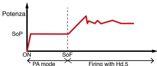
L'opzione viene abilitata con il parametro dry.E. Si entra nella fase di asciugatura al momento del power-ON o ON-Software dello strumento.
