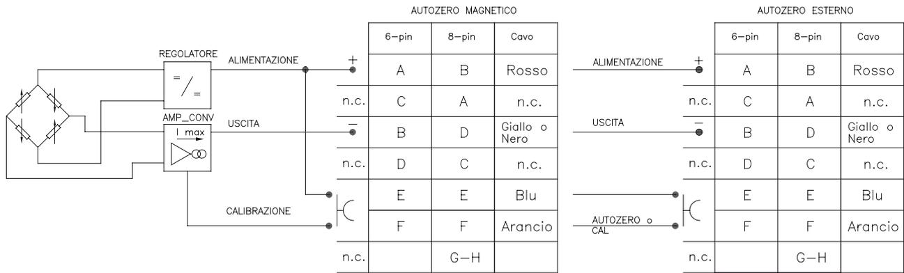
La calza del cavo è collegata ad entrambi i lati: al connettore del trasmettitore e al controllore
