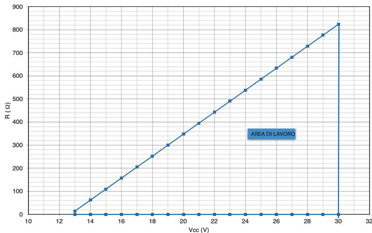
Nel diagramma riportato è rappresentato il rapporto ottimale tra il carico e l'alimentazione per trasmettitori con uscita 4...20mA.
