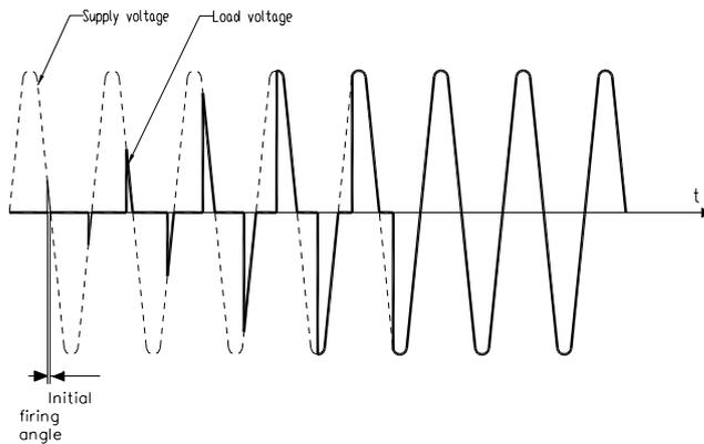
DT - "Delay triggering" Ritardo di innesco del primo ciclo (solo per modalità di controllo ZC, BF, monofase) Impostabile da 0° a 90°.
