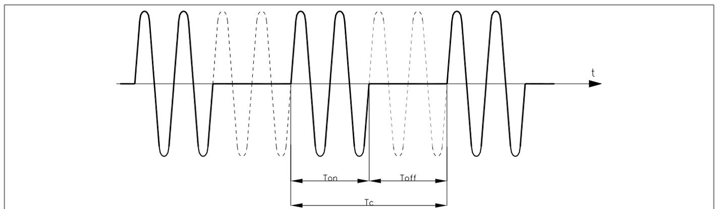
Esempio di funzionamento in modalità BF con potenza pari a 50% .
