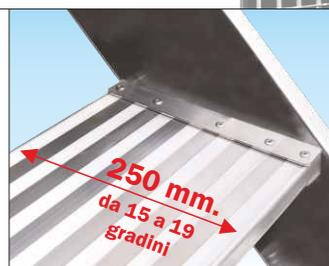
**Gradino piano profondo 250 mm. e montante 200 mm. per misure scala oltre i 16 gradini** Il gradino maggiorato profondo 250 mm. e l'inclinazione di salita a 45° garantiscono la massima comodità durante la salita e discesa anche con materiali ingombranti. Il montante maggiorato per misure scala oltre i 16 gradini garantisce grande solidità e annulla ogni flessione della rampa durante l'uso.
