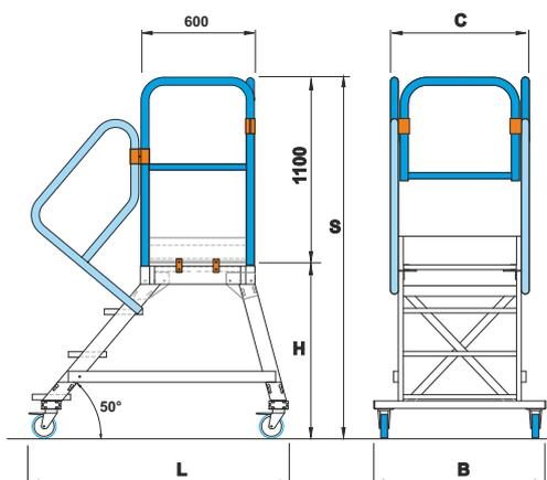
**Scala con cavalletto posteriore inclinato conforme EN 131-7 senza l'uso di zavorra !**
