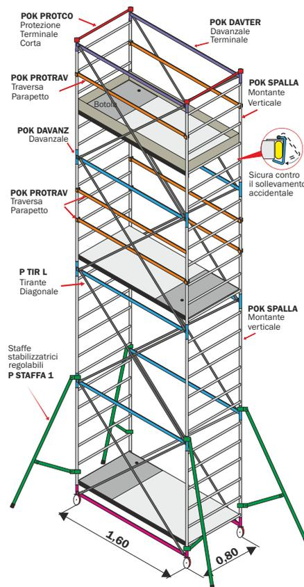
**Base rigida con montaggio e smontaggio rapido** dotata di ruote Ø 150 mm consente l'uso di stabilizzatori a vite (optional) ed è composta da n° 4 elementi con montaggio ad incastro e bloccaggio mediante spine passanti, può essere montata e smontata in modo facile e veloce senza viti e senza bulloni da stringere e non richiede l'uso di utensili.
