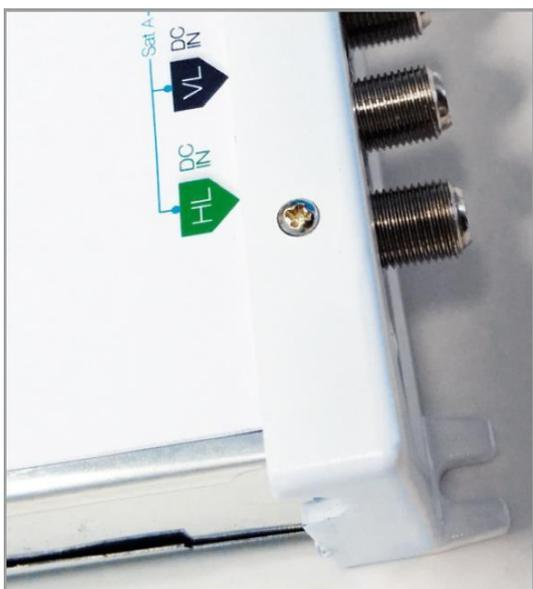
**I:** Connettere l'alimentatore alla porta DC del prodotto (in basso a sinistra) **IMPORTANTE:** utilizzare solo l'alimentatore opzionale (PSU1215TS o PSU1240TS), una tensione non corretta (es. 18V) potrebbe danneggiare il prodotto. L'amplificatore può essere alimentato anche da trunk, la tensione deve essere **compresa tra i 12V ed i 14V; se viene utilizzata una tensione maggiore (es. 18V) l'amplificatore si danneggia.**
