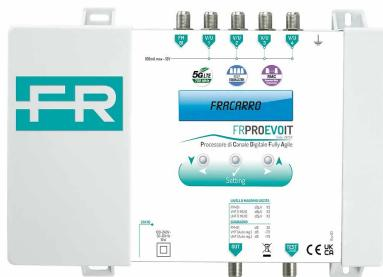
**Centrale programmabile** per il filtraggio altamente selettivo dei canali televisivi con **5 ingressi** (BI+FM, 4x VHF/UHF flessibili) e livello di uscita 113dB $\mu$ V per ciascun filtro. **32 filtri da 1 a 6 canali**, ciascuno con 8 livelli di selettività. Dalla Rev.03 sono state aggiunte le nuove funzionalità: **Self equalizer** e **RMC**
